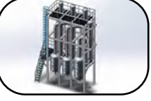
降膜浓缩蒸发器 Falling Film Evaporator
